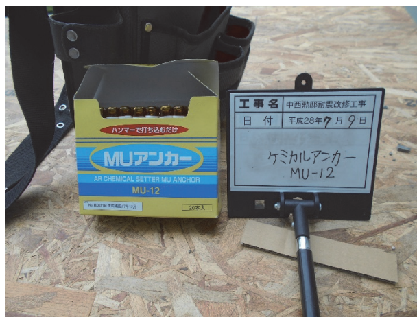
ケミカルアンカー M12 用
